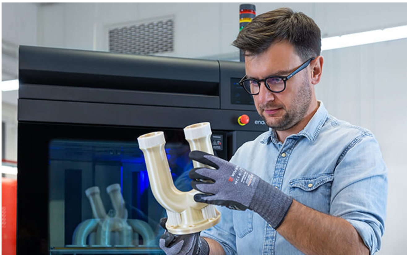
使用 Z-PEI 9085 3D 打印的承重航空航天级组件。
