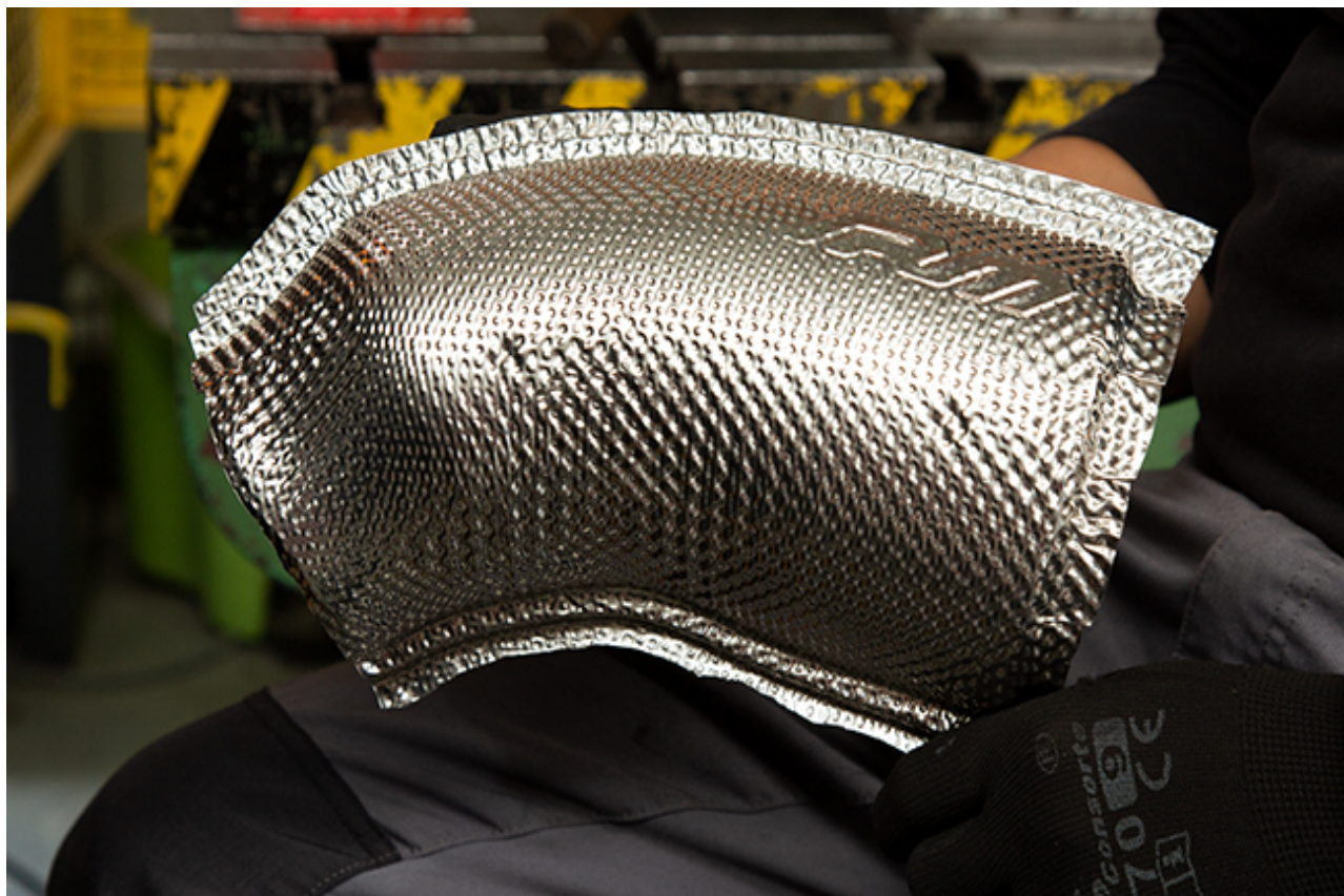
目标隔热层采用 3D 打印的模具和冲压件定制的辊压机冲压而成，并带有 RM Motors 徽标。
