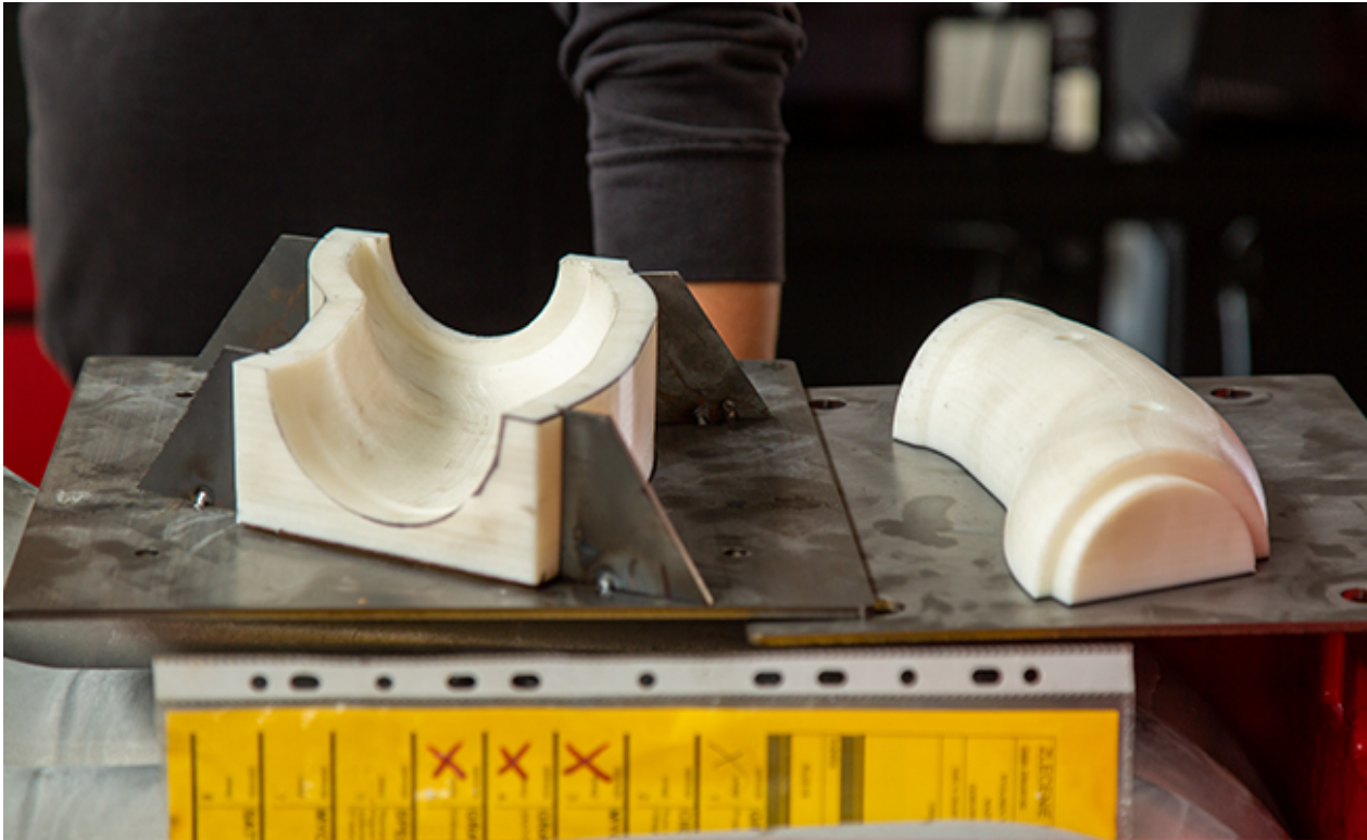
在 Zortrax Endureal 工业 3D 打印机上打印的两个部件，用于升级汽车车间的辊压机：模具和冲压件。
